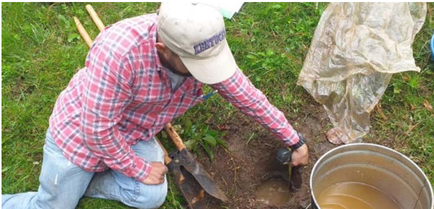
Figura 2: Realización de pruebas de infiltración en una de las unidades de mapeo.
